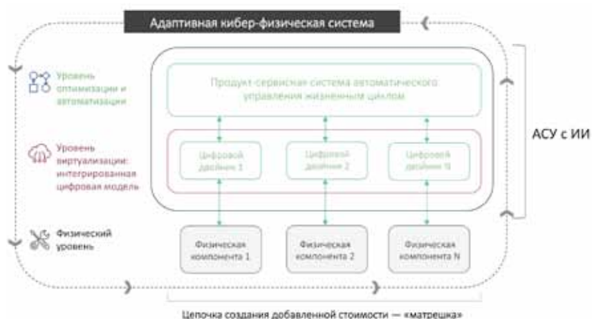
Рис. 1. АСУ с ИИ – кибер-компонента самоадаптирующейся кибер-физической системы
